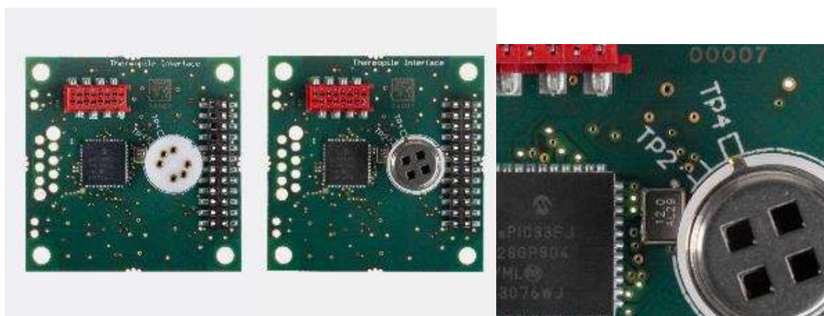
热电堆接口上方视图 - 右图含 4 通道热电堆
